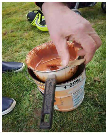
Préparation et chauffage de la colle
